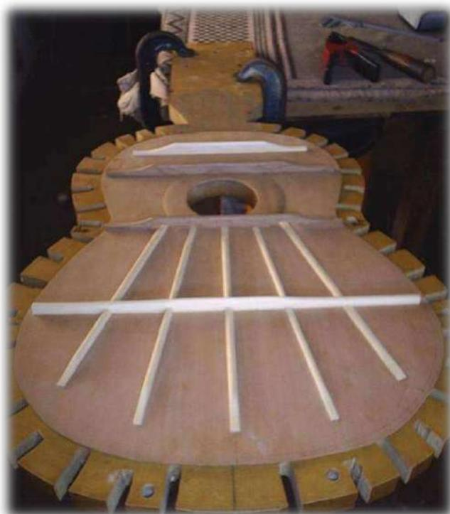
Bouchet konstrukcija zvučne ploče.
